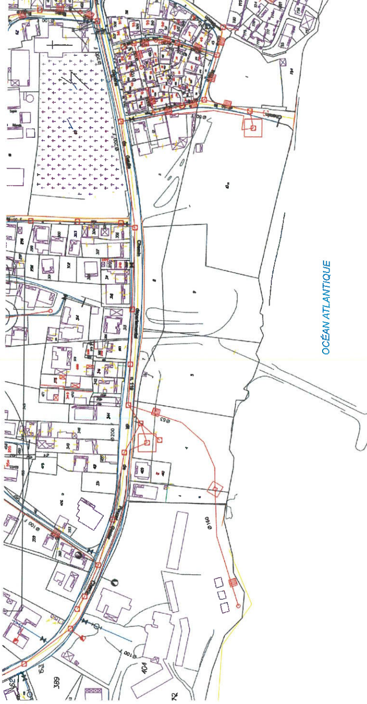
Réseau d'eau potables dans le centre-bourg du Gosier (Source : Infraplus 2019)
