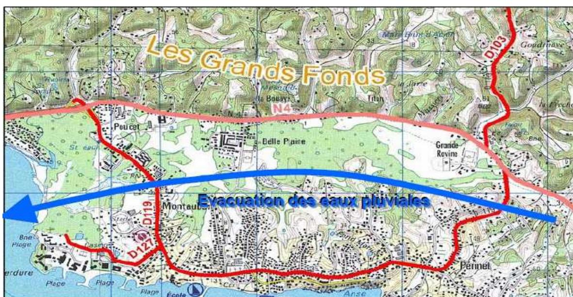
Les ouvrages hydrauliques de franchissement de la **RD119 (lieu-dit, Montauban)** ne possédant plus les gabarits nécessaires (urbanisation, démographie, etc.), permettant une évacuation efficace des eaux en cas de fortes pluies, par submersion la plaine de Belle plaine et l'entrée du Bourg du Gosier se retrouvaient coupés et isolés du reste du territoire.
